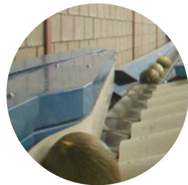
Transportador de correa con ondas motorizadas para garantizar el alineamiento.
